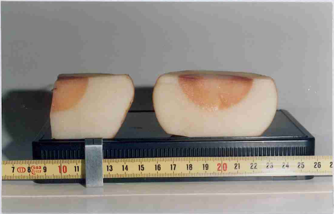
ציור 7.8: חתך של תפויא בניצב לפני השטח המתוארים בציור 7.6. למישור חזית הקיפאון צורה חצי כדורית בקירוב.
