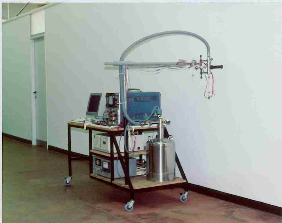
ציור 6.4: מבט כללי על המערכת הקריוכימורגית הניסויית מהחזית (למעלה) ומכיוון יחידת אספקת החנקן (למטה).
