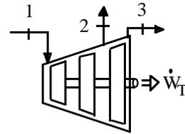
Energy Eq.:  $\dot{Q}_{CV} + \dot{m}_1 h_1 = \dot{m}_2 h_2 + \dot{m}_3 h_3 + \dot{W}_{CV}$  ;
